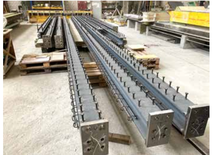
So werden die Träger angeliefert. Die Längsten sind knapp 14 Meter lang, die Kürzesten rund 4 Meter.
