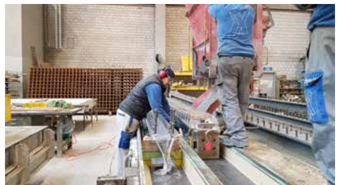
Der Träger erhält seinen Betonkragen.
